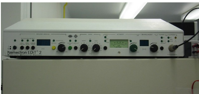
Abb. 11: Signalgenerator Nemectron EDIT2 zur Interferenzstromerzeugung
