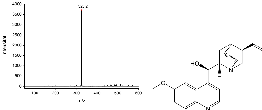
Abbildung 68: Full-Scan DESI-MS Spektrum (links) der Tablette mit der Mischung A und optimalen Pressdruck. Struktur von Chinin (rechts).
