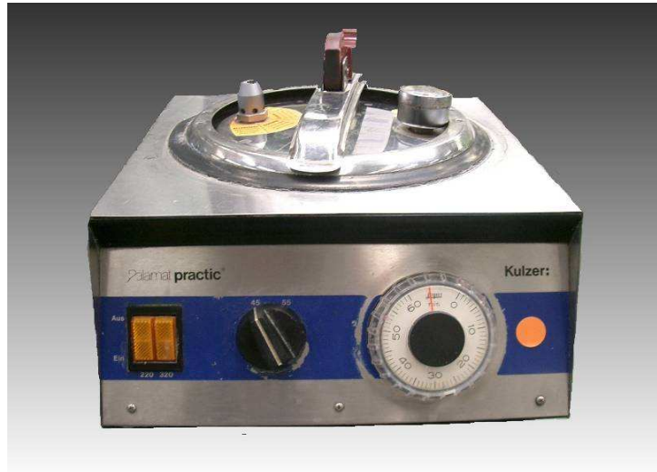
Abbildung 4: Der verwendete Drucktopf Palamat (Heraeus Kulzer, Hanau, Germany)
