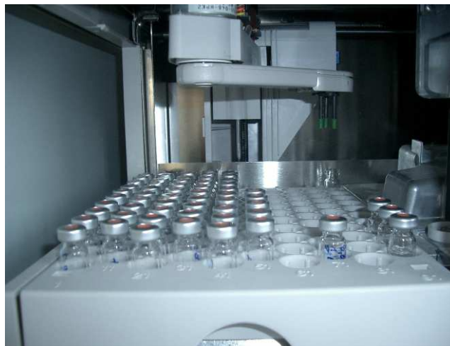
Abbildung 14: Autosamplern des HPLC Gerätes (Agilent 1100 Series, HP)
