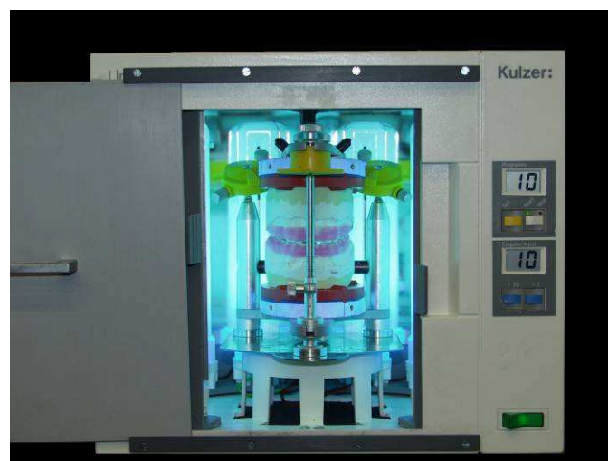
Abbildung 5: Verwendeter Lichtofen Unilux AC (Heraeus Kulzer, Hanau, Germany)
