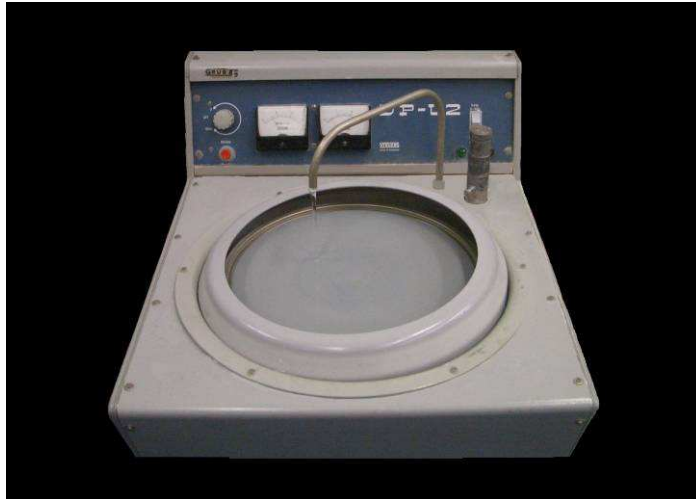
Abbildung 7: Das verwendete Schleifgerät DP-U2 der Firma Struers (Ballerup, Dänemark) mit Wasserkühlung
