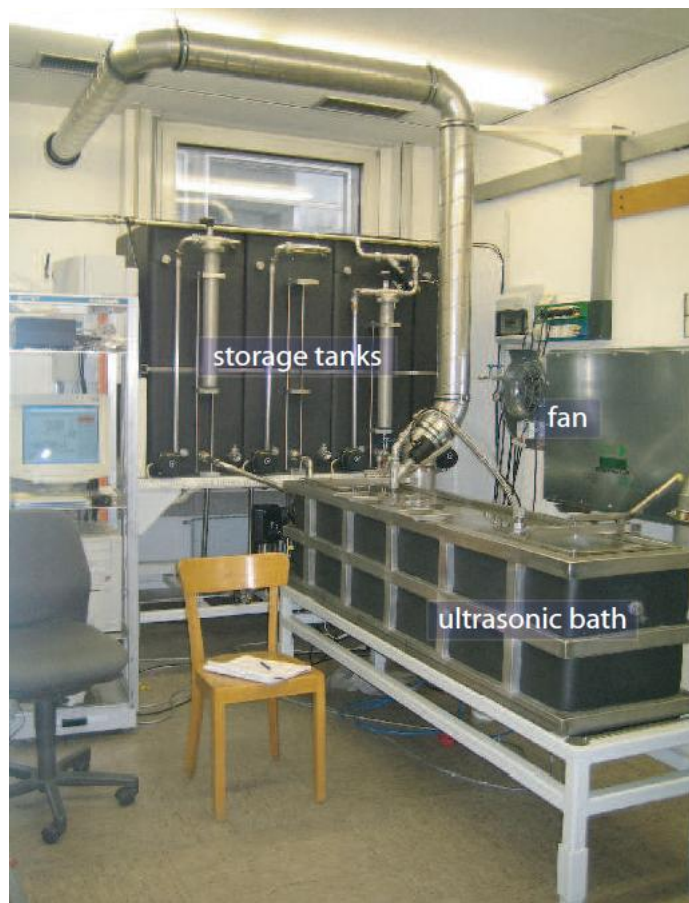
Abb. 4.19.: Im Ultraschallreinigungsbad werden alle Edelstahlkomponenten der Drahtelektrode gereinigt. Das Bad im Vordergrund lässt sich durch vier Tanks befüllen. In zwei der Tanks befinden sich Reinigungsmittel, in einem Reinstwasser zum Befüllen des Bades und im letzten Tank befindet sich Reinstwasser zum Abspritzen der Bauteile. Dies ist der einzige Tank, in dem die Flüssigkeiten aus dem Bad nicht zurückgepumpt werden können. Er wird jedesmal nach Benutzung neu gefüllt. Die Steuerung der Ventile, Pumpen und Gebläse erfolgt mittels eines selbst entwickelten Programms, das auf dem Steuerungsrechner ganz links im Bild zu erkennen ist. Abb. aus [Tem07]
