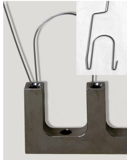
(b) Prinzip der Steckverbindung zum Verbinden der Spannungsdurchführung mit dem Modul
