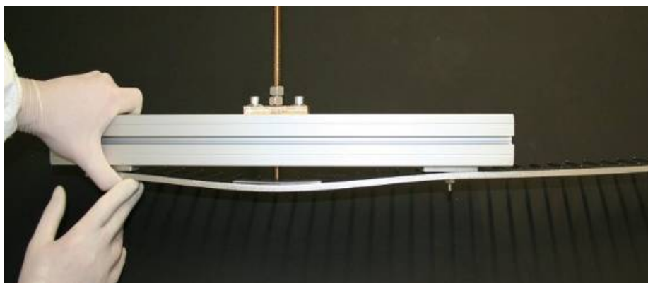
Abb. 4.23.: Das Vorbiegen eines Kammes wird mittels einer Schraube realisiert, die den Kamm exakt an der Position zwischen zwei C-Profilen in die entgegengesetzte Richtung mechanisch überdehnt. Der Kamm verbiegt sich dabei um etwa 1 mm – 2 mm permanent. Das Vorbiegen wird für beide Käme eines Modules durchgeführt.
