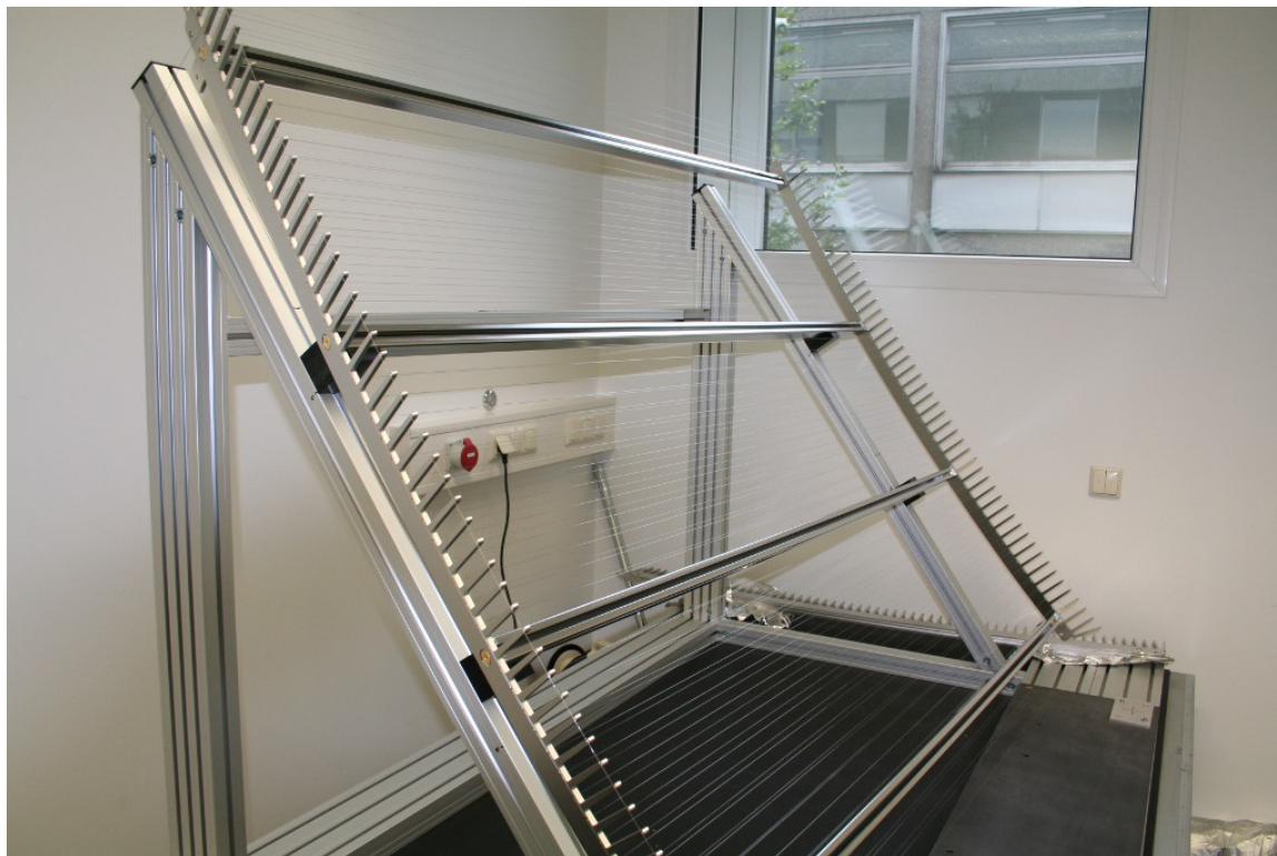
Abb. 4.1.: Aufbau eines typischen Drahtelektrodenmoduls. Ein Modul besteht neben den Drähten selbst aus zwei Haltestrukturen, um die einzelnen Drähte zu halten (im folgenden werden sie aufgrund ihrer Form Kämmen genannt) und drei bis vier C-Profilen, die das Modul aufspannen.
