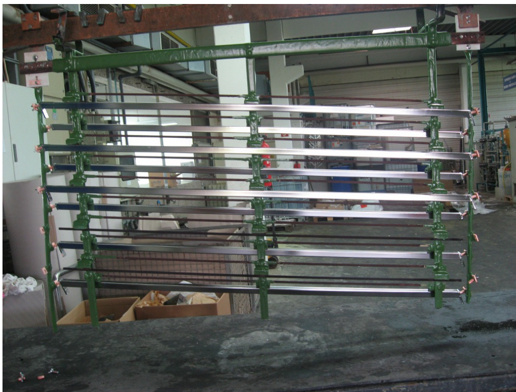
Abb. 4.18.: Elektropoliergestell mit eingespannten C-Profilen. Im Gestell sind acht C-Profile für den konischen Bereich des Spektrometers eingespannt. Im Inneren besteht das Gestell aus Kupfer, welches den Strom gut leiten kann. Außen befindet sich eine grüne Schutzschicht aus Polyurethan, um das Gestell vor den aggressiven Säuren im Bad zu schützen. Nur die Teile des Gestells, die als Innenelektrode dienen, liegen frei.
