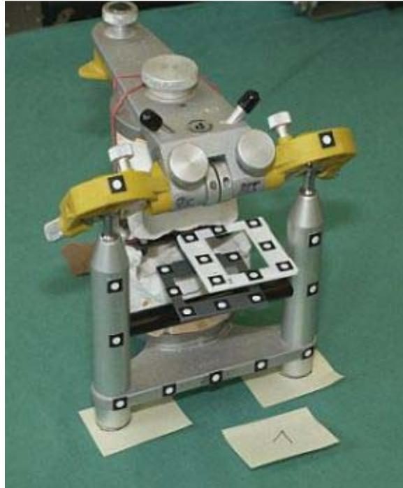
**Abbildung 3:** Modellpaar mit darauf befestigten Messmarken im Artikulator
