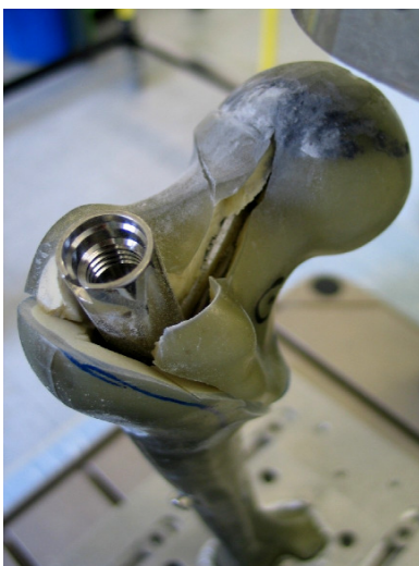
Abb. 24. Längsfraktur im Caput-Collum-Fragment
