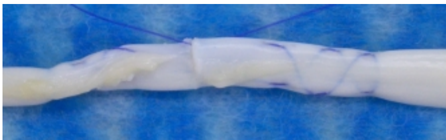
Abb. 9 Naht nach BUNELL (Nahtmaterial PDS 5/0) vor biomechanischem Versuch (Nahtanteil des linken Sehnenstumpfes ist durch ein Stück des Sehnenschlauches verdeckt)
