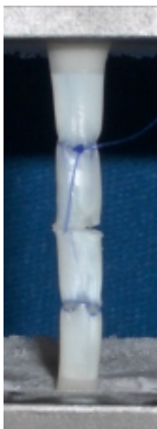
Abb. 7 Naht nach Zechner (Nahtmaterial PDS 5/0) zu Beginn eines Maximallastversuches
