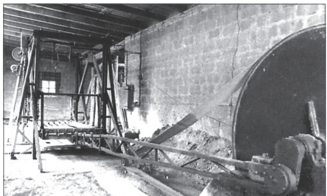
Abb. 92: Sägegatter von 1952 Quelle: Eichler, Joachim (1993) S. 16.
