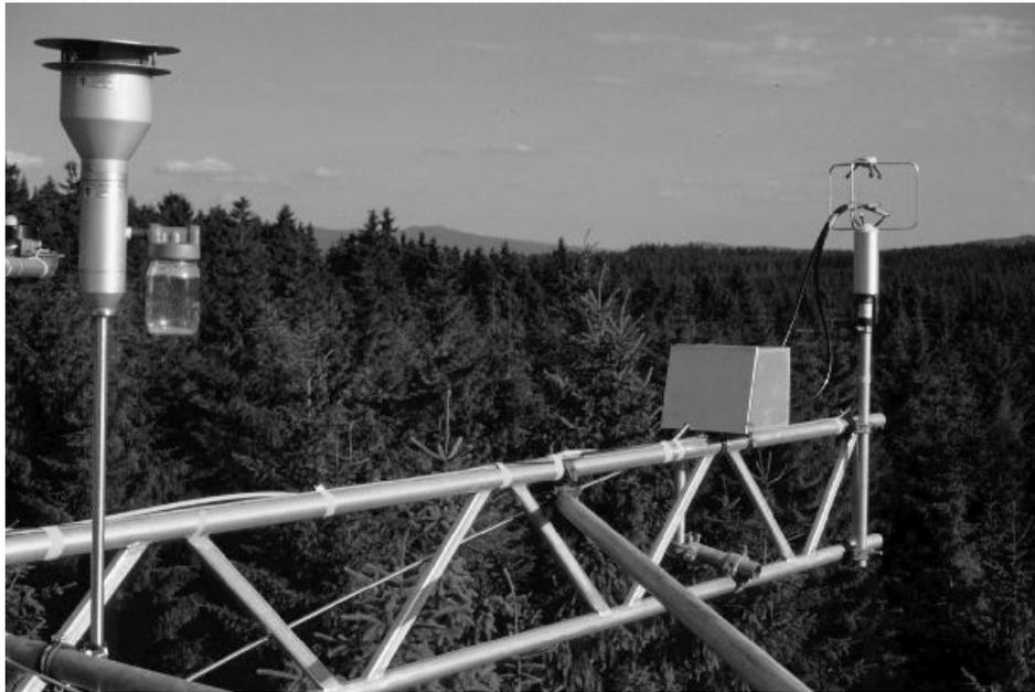
Abbildung 2.10: Das Partikelfluss-System in 22 m Höhe an der SE-Ecke des Messturms: Rechts das Ultraschallanemometer mit den Aerosolleitungen, links daneben die Schutzhütte des CPC. Ganz links im Bild ist der  $PM_{10}$ -Einlasskopf des DMPS-Systems zu erkennen.
