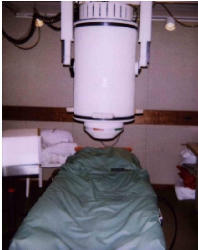
Abb.6: Das Innere der Messkammer mit dem frei aufgehängten Messgerät (DEWARE) über einer körperstabilisierenden Vakuumliege.
