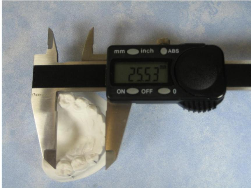
Abbildung 25: Aufsicht auf ein Oberkiefermodell: Darstellung der manuellen Messung der Zahnbogenlänge mit Hilfe der digitalen Schieblehre.
