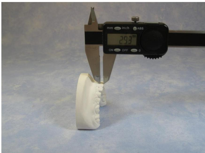
Abbildung 41: Darstellung der Overbitemessung an einem Unterkiefermodell mithilfe der digitalen Schieblehre.
