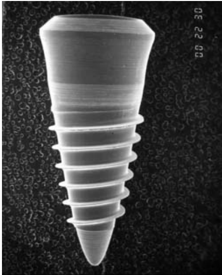
Abbildung 6: Elektronenmikroskopische Aufnahme des Implantats, Länge 10mm
