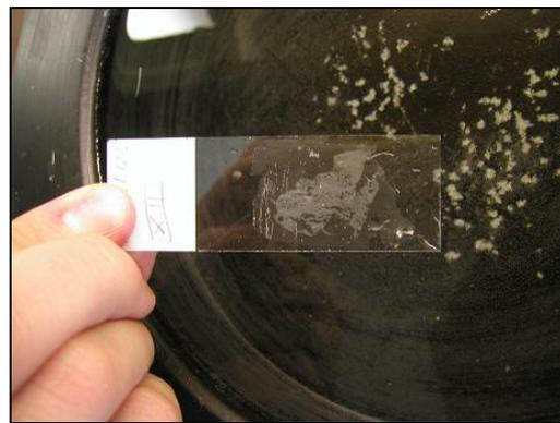
**Abbildungen 25 und 26:** Anfertigung eines Schnittpräparates mit Hilfe eines Microtoms
