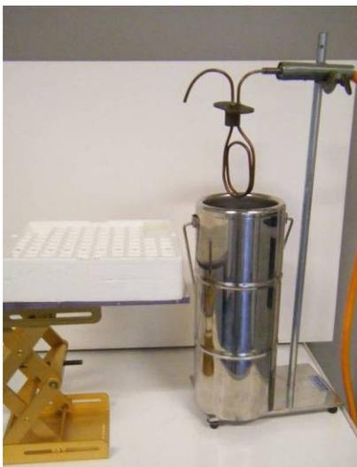
**Abb. 21** Wendelförmig gedrehtes Rohr mit Styroporauffangbehälter
