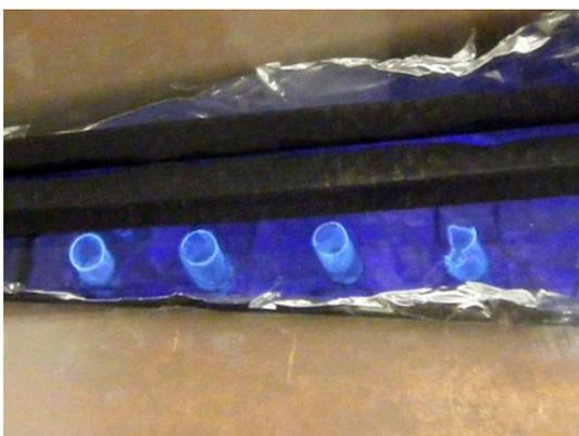
**Abb. 23** UV-Polymerisationskammer mit flüssigem Methanol
