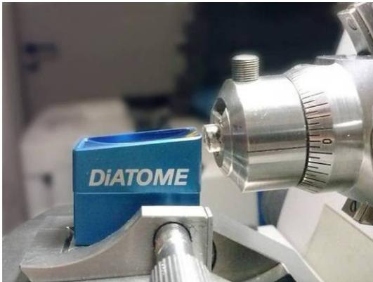
**Abb. 28** Ultracut mit eingespannter Probe und Diamantmesser
