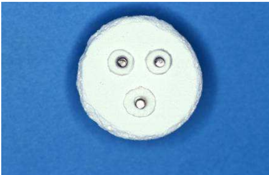
Abbildung 21 Implantatscheibe mit 3 Abstandshaltern
