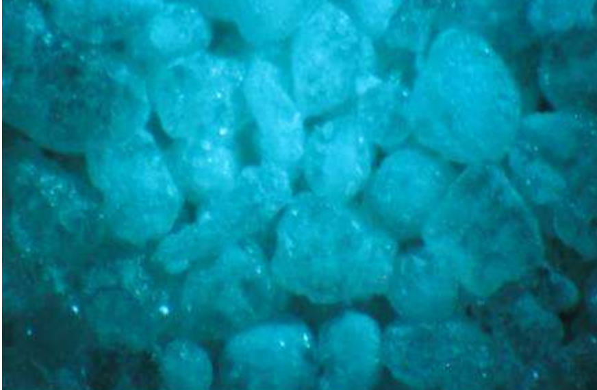
Abbildung 4 Kornspektrum 600–1000 \mu\text{m} , Implantat Nr. 17, 40 fache Vergrößerung
