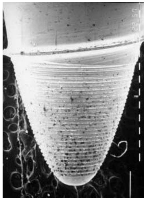
Abb. 12: Mikrorelief im apikalen Bereich
