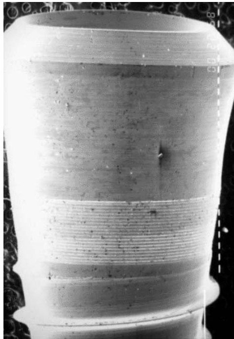
Abb. 11: Mikrorelief im Bereich der Implantatschulter
