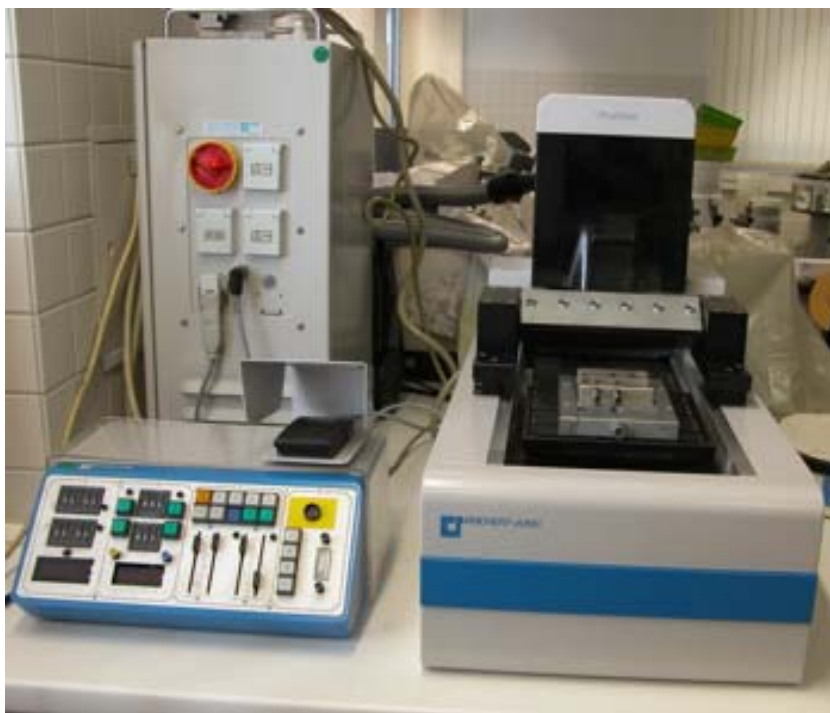
Abb.22: Mikrotom vom Typ Polycut E
