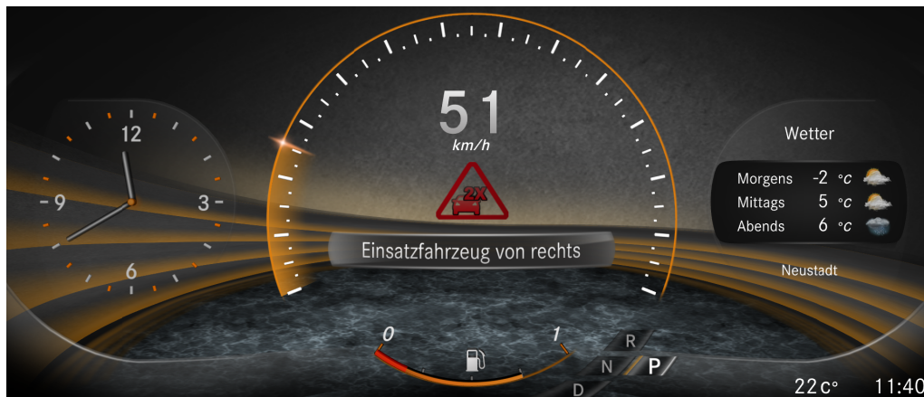
Abbildung A.3: Konzept 1: Tachometer mit künstlich erzeugter Warnmeldung vor Fahrzeug von rechts, wie es im Fahrsimulatorversuch eingesetzt wurde.
