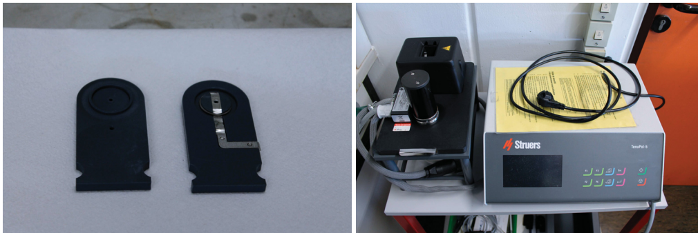
Abbildung 27: Elektropolieren. Links: Der Probenhalter aus Teflon mit der Platinelektrode. Rechts: Foto des Tenopol 5.
