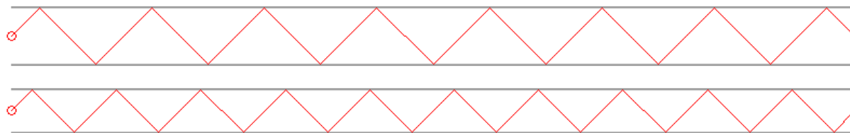
Abb. 64: Strahlengang zwischen den Deckplatten der spiralförmigen Gassensoroptik in der Queransicht. Im oberen Fall beträgt der Plattenabstand 8 mm, im unteren Fall 6 mm. Die Entfernung zwischen dem Emittor und der grün eingezeichneten Detektorfläche beträgt in beiden Fällen 120 mm. Die Höhe der Detektorfläche hat einen Wert von 5,5 mm.
