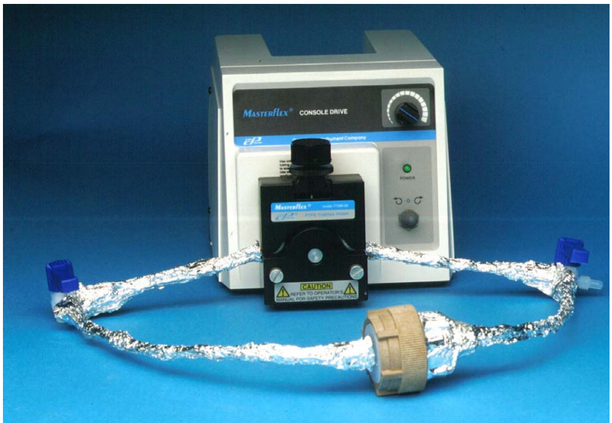
Abbildung 4: Pumpe mit Schlauchsystem
