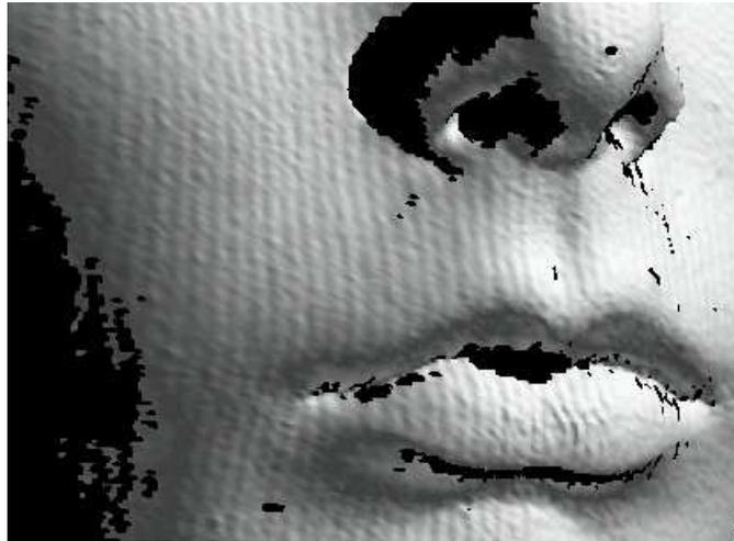
**Abbildung 5.11:** Ausschnitt einer gemessenen, triangulierten Gesichtsoberfläche eines Probanden. Deutlich ist das charakteristische Wellenprofil infolge des Phasenfehlers zu erkennen, das durch minimale Bewegungen des Probanden bei der Vermessung entsteht.
