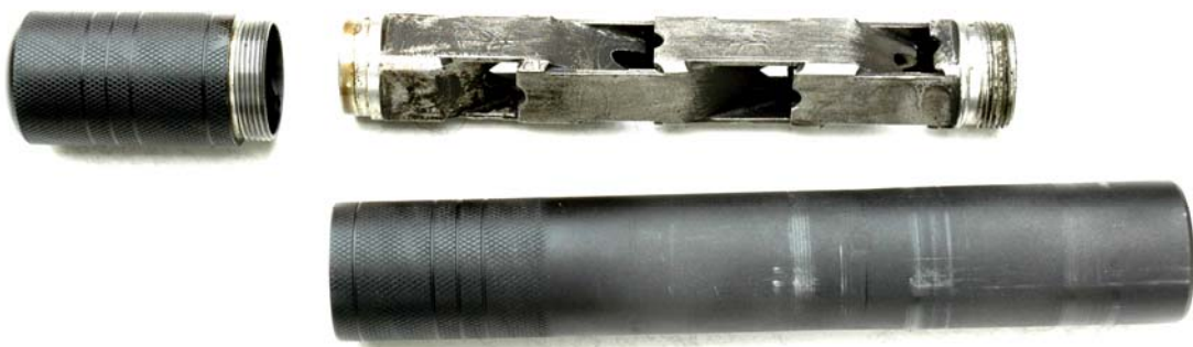
MP 5 SD, Kal. 9 Para, Innenaufbau des Geometriedämpfers
