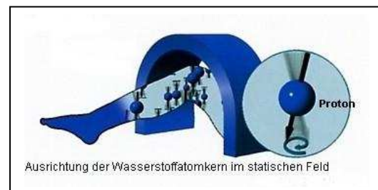
Abb.5: Zustand im statischen Magnetfeld (geordnete, parallele oder antiparallele Lage der Kerne)
