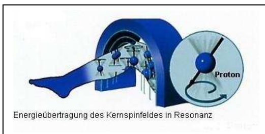
Abb.6: Zustand nach Einschalten des Störfeldes (M2) (Präzession der Kerne)
