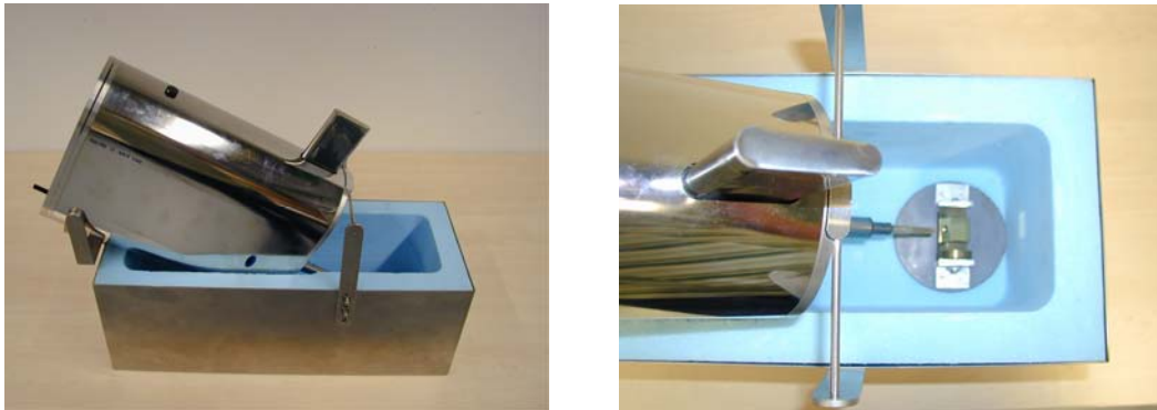
Abbildung 7: Schleusen- und Transportbox in Probenübergabewerkzeug. Im linken Bild von der Seite, im rechten von oben abgebildet.
