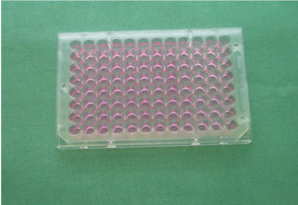
Abbildung 5: 96-well-Platte mit Agarose beschichtet
