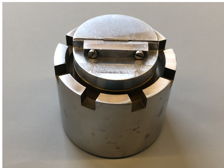
Abbildung 126: Schleifhalter für die Präparation der Biegeproben
