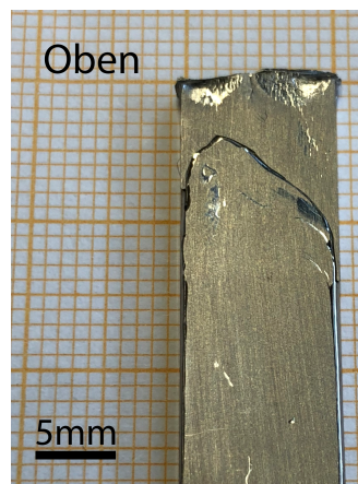
Abbildung 62: Angeschliffene PdNiP Probe nach dem Guss
