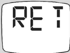
Wenn die Diebstahlsicherung aktiviert ist und das Thermometer nicht gerade zum Messen verwendet wird (Stand-by-Betrieb), zeigt es die verbleibende Zeit an, bevor es gesperrt wird.
