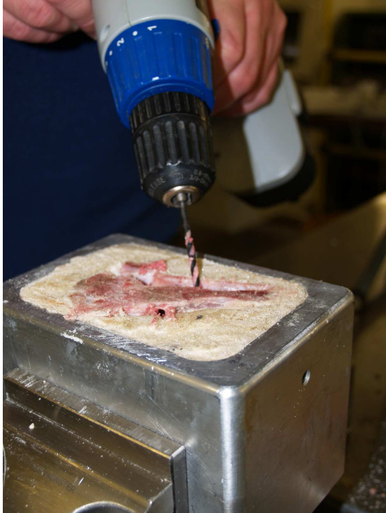
Abbildung 13: Vorbohrung im Sakrumwirbelkörper im 45°- Winkel zur Kortikalis
