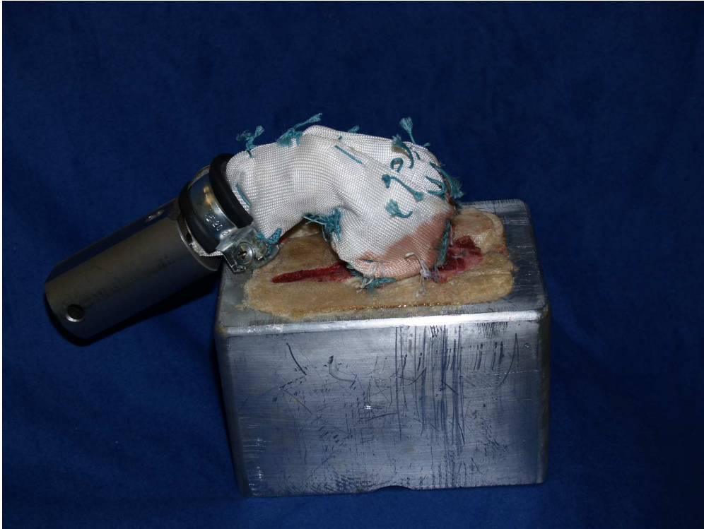
Abbildung 8: Eingespannte Tumorprothese am fixierten Schweinesacrum
