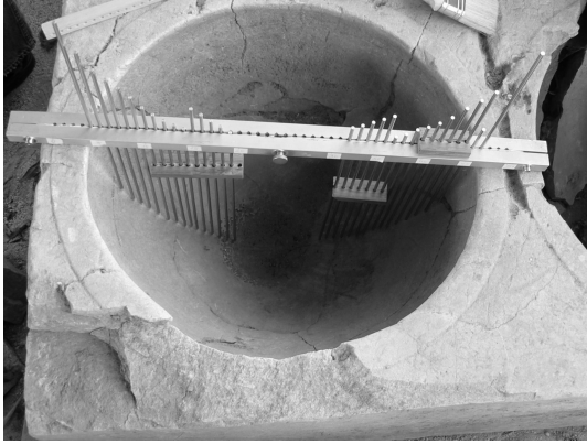
Abb. 12(a): Der erste 'große Profilkamm' in Kavität A in San Vincenzo (Kat. 35); der Überhang ist kaum wahrzunehmen. In der Mitte und an den beiden Enden sind die Stellschrauben zur Fixierung der Nadeln zu erkennen.
