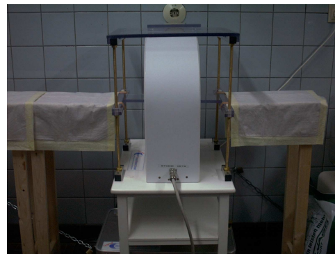
Abb. 8 und Abb. 9: Ansicht der Therapiespulen mit angebauter Liegefläche für die zu therapierenden Tiere.
