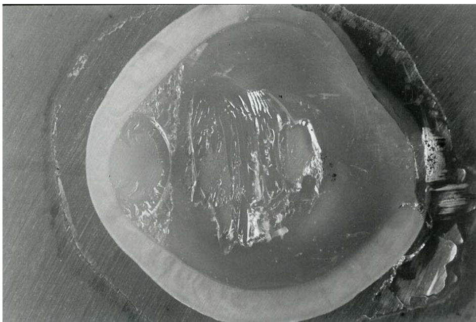
Abb. 3: Aufnahme einer beispielhaften Testkörperoberfläche für die Testreihen der Dentin - Haftvermittler nach erfolgtem Scherversuch.
