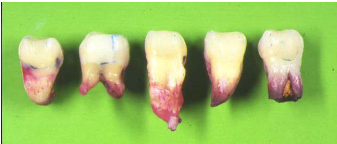
Abb. 9 + 10: Mit Dentin - Haftvermittler Prompt L-pop gelegte MO/OD - Komposit - Füllungen nach 2500 - facher Belastung mit 250 Newton
