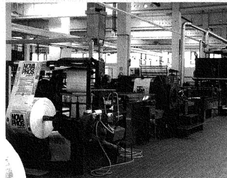
*Die AD-Plasticmaschine zur Herstellung geklebter PE-Ventilsäcke*
