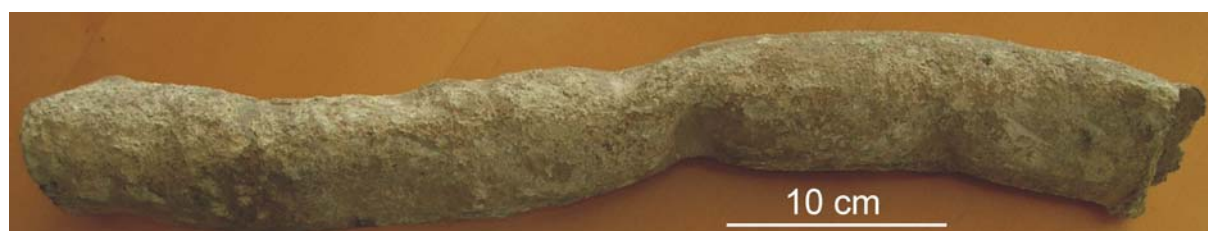
Foto 2.1: Teil einer in Haltern verbauten Wasserleitung (D-137/22) aus dem Römermuseum Haltern.
