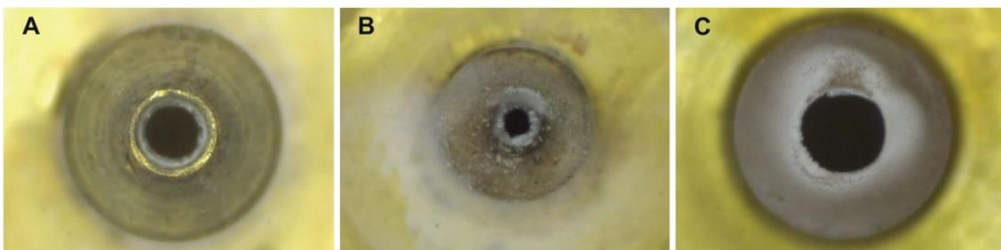
**Abb. 5.2** Verschiedene Samplerspitzen nach unterschiedlichen Betriebszeiten mit der Niedrigfluss-Ionenquelle (A: Ø 0,7 mm, 2 h; B: Ø 0,7 mm, 10 h; C: Ø 1,0 mm, 5 h (alle Samplerdesigns: Spitzer Samplerkopf)).
