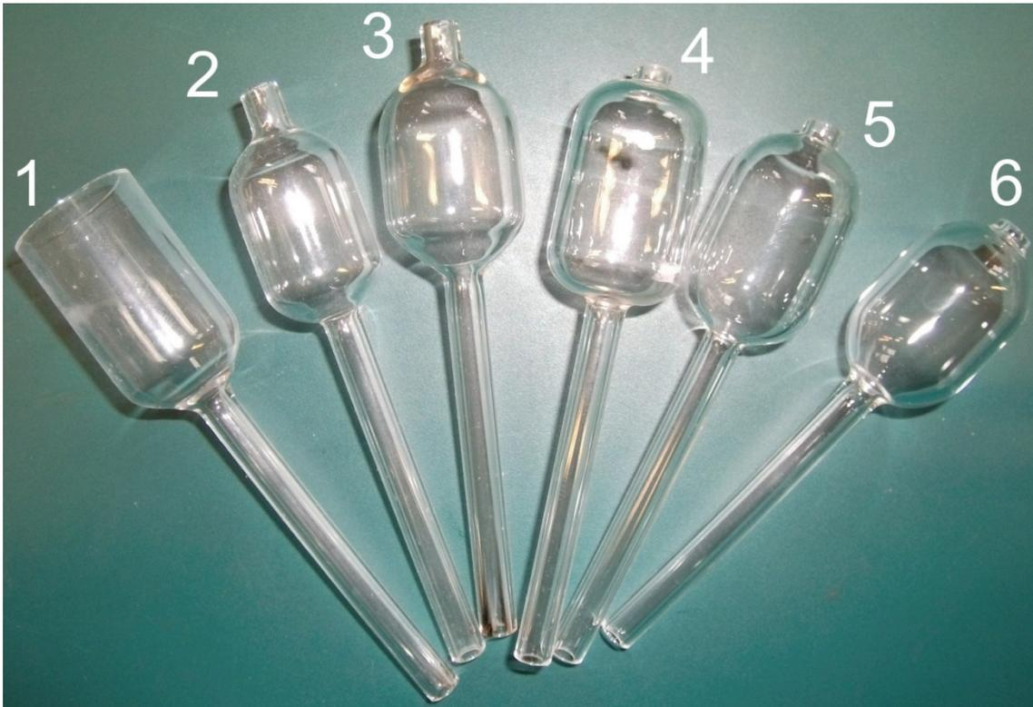
**Abb. 4.3**      **Verschiedene Fackelgeometrien, die während des Optimierungsprozesses der Fackelgeometrie getestet worden sind (Einzelheiten siehe Text).**
