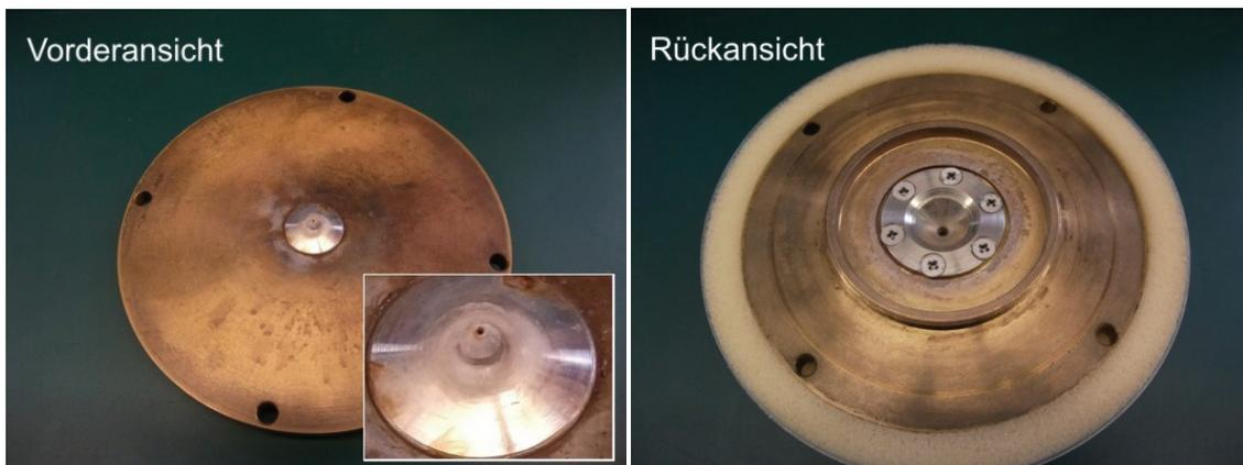
Abb. 4.24 Vorder- und Rückansicht der Samplerbasis mit eingebauter Ni-Samplerspitze.
