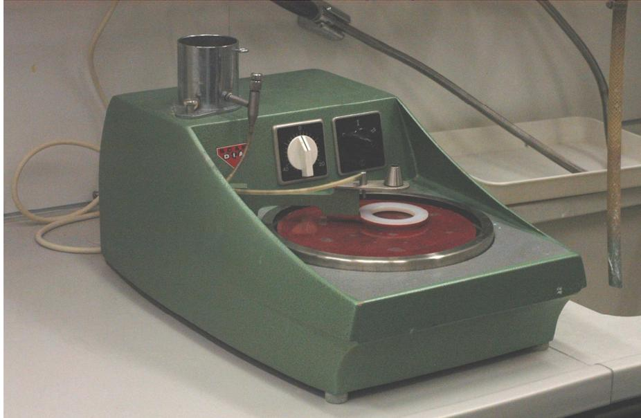
Abbildung 7: Schleif- und Poliergerät SCANDIMATIC
