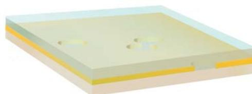
(d) Spin-coating mit einer Farbstoff-PMMA-Lösung
