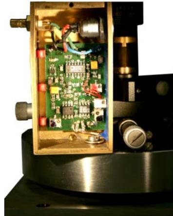
Abbildung 5.2: Die für die Abstandskontrolle eingesetzte Elektronik [34]
