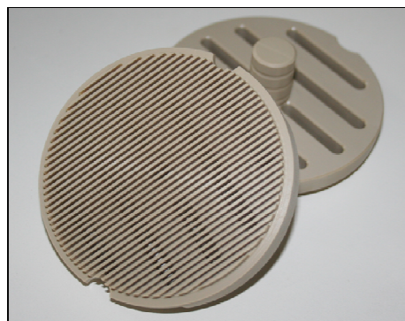
Abb. 4.1: Spezifische Stempel zur Anzucht von Zellen in 10 cm-Kulturschalen. Diese Stempel bestehen aus einem Polyethylenketon, das über besondere thermische Eigenschaften verfügt. Im Vordergrund ist die Unterseite mit einer großen Anzahl an Stegen zur Erzeugung vieler zellfreier Räume zu sehen. Im Hintergrund ist die Oberseite des Stempels abgebildet. Die Löcher dienen zum Einfüllen des Mediums bzw. der Zellsuspension.
