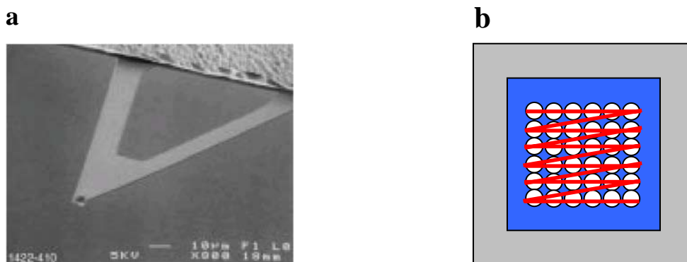
Abbildung 2.5 (a) Raster-Elektronen-Mikroskopieaufnahme eines cantilevers . Am oberen Ende des cantilevers ist die Spitze zu erkennen, mit der der Kontakt zur Probe hergestellt wird. (b) Abrasterung der Probe \circ = Messpunkte, - = Messweg der SFM Spitze.
