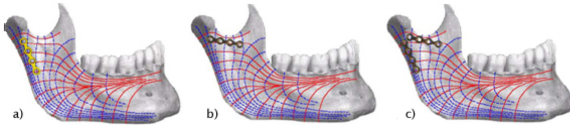
Abb.: 12 Abb.: (a) zeigt die optimale Lage der posterioren Platte auf den Drucklinien (blau) (b) zeigt die optimale Lage der anterioren Platte auf den Zuglinien und (c) zeigt die Verplattungsempfehlung nach Choi bestätigt durch Wagner
