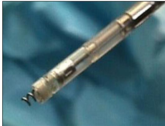
**Abbildung 4: Schraubelektrode**
