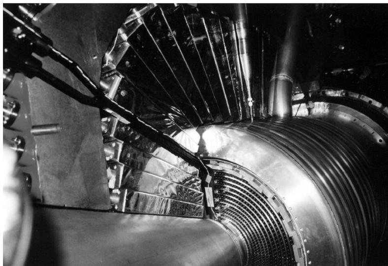
Abbildung 2.16.: Fotografie des Zentraldetektors. Die Mini Drift Chamber ist umgeben von Elementen des Plastic Scintillator Barrel. Noch weiter außen sind auch Elemente des Kalorimeters zu sehen.
