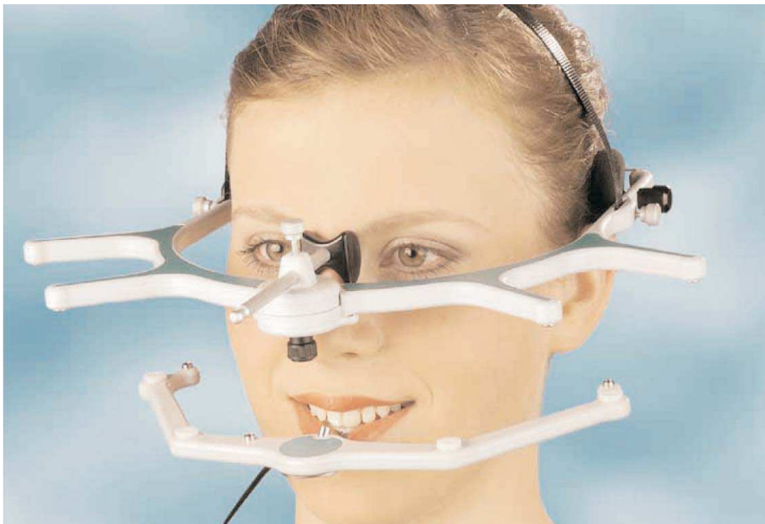
Abbildung 13: Anordnung der Meßsensorik des JMA Systems (Quelle Zebris)
