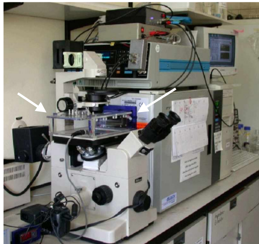
Abb. 3.27: Experimenteller Aufbau für die ECIS-Experimente mit ITO-Elektroden. Das ITO-Substrat befindet sich in dem Kunststoffaufsatz, der auf 37 °C temperiert wurde, und ist über Metallspangen auf dem Mikroskoptisch kontaktiert. Die verschiedenen Arbeitselektroden können über ein Relais-Modul angesteuert werden, welches mit einem Impedanzanalysator (Solatron Instruments, SI 1260) verbunden ist. Relais-Modul und Impedanzanalysator wurden von einem handelsüblichen PC gesteuert, der auch zur Datenaufnahme und -sicherung diente.
