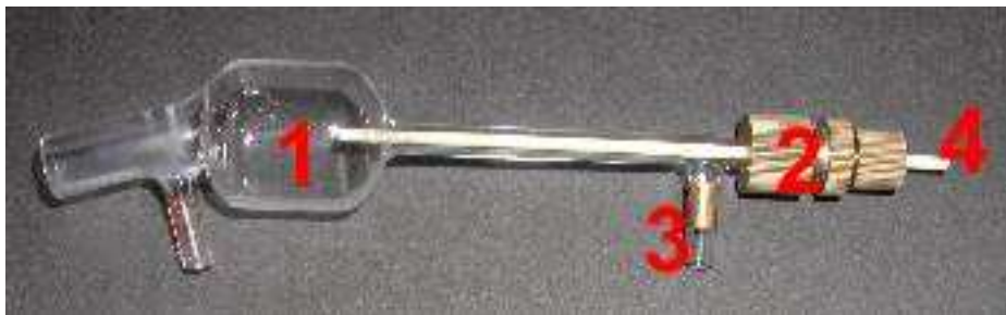
Abbildung 35 : Darstellung des offenen Zylinders 2 nach einer Versuchsreihe zur Reduzierung des Kühlgasstromes
