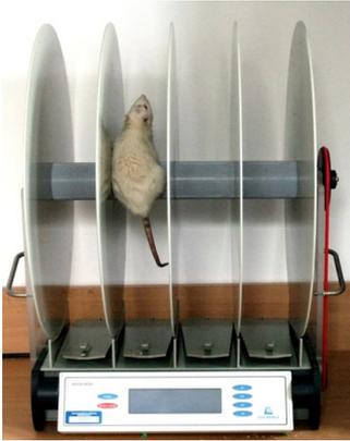
*Abbildung 2: Rota Rod Test*
