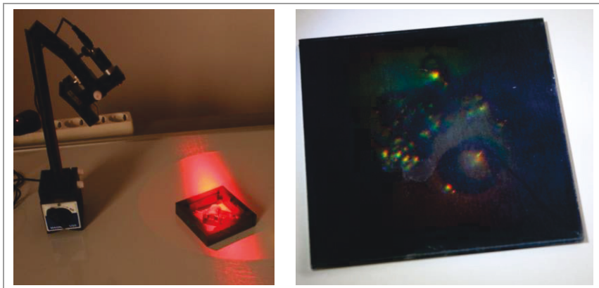
Abbildung 31: Aufnahme eines Hologramms mit einem Aufbau nach Denisyuk | rechts: entwickeltes Hologramm
