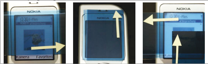
Abbildung 28: Demonstration der Funktionsweise eines Polarisationsfilters mit einem Flüssigkristallbildschirm als Hintergrund
