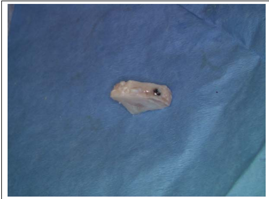
Abb. 9: Einzelner Probenblock mit inseriertem Implantat.
