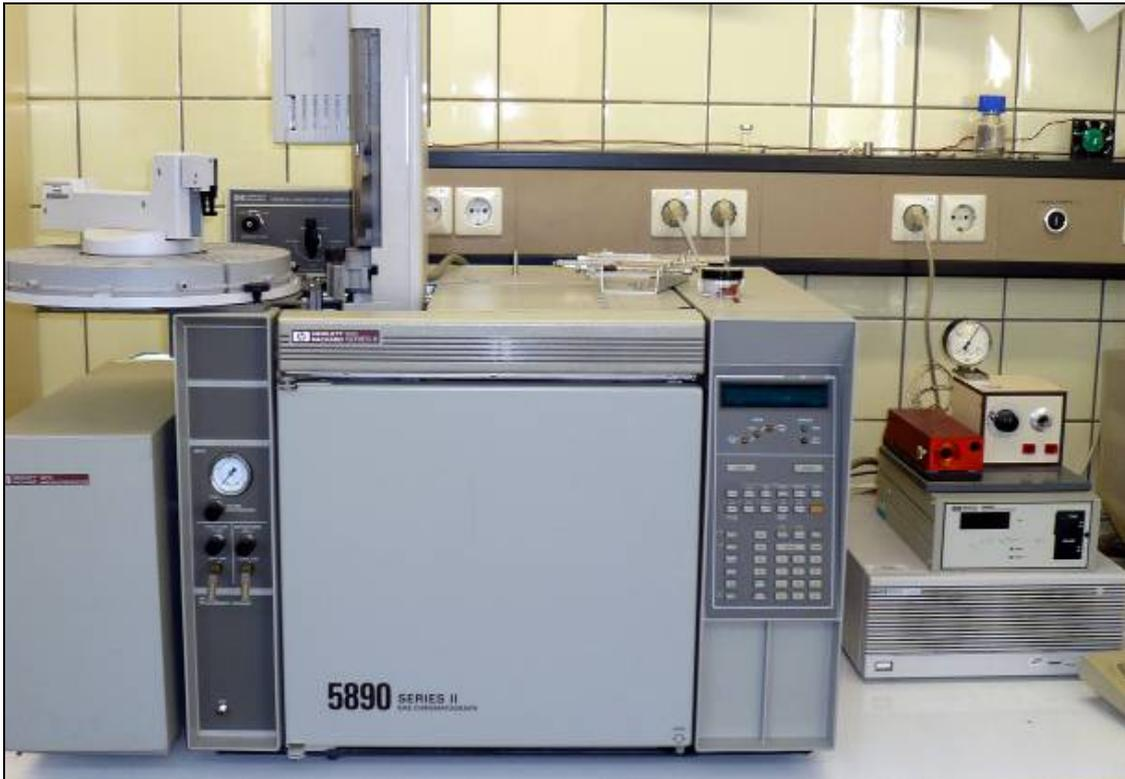
**Abbildung 1: Gaschromatograph 5890 Series II**
