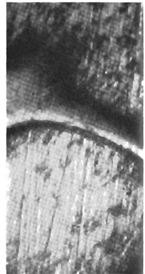
Abb. 2. Kunststoffoberflächen nach unterschiedlich langer Beschichtung mit „Strahler 70“ a) 15 min, b) 15 h (112 : 1), c) 12 h (551 : 1).
