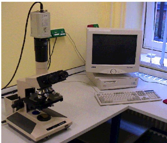
Die Abbildung zeigt die Telepathologiestation mit Olympus BH2, CCD-Kamera Sony und PC und Bildschirm.
